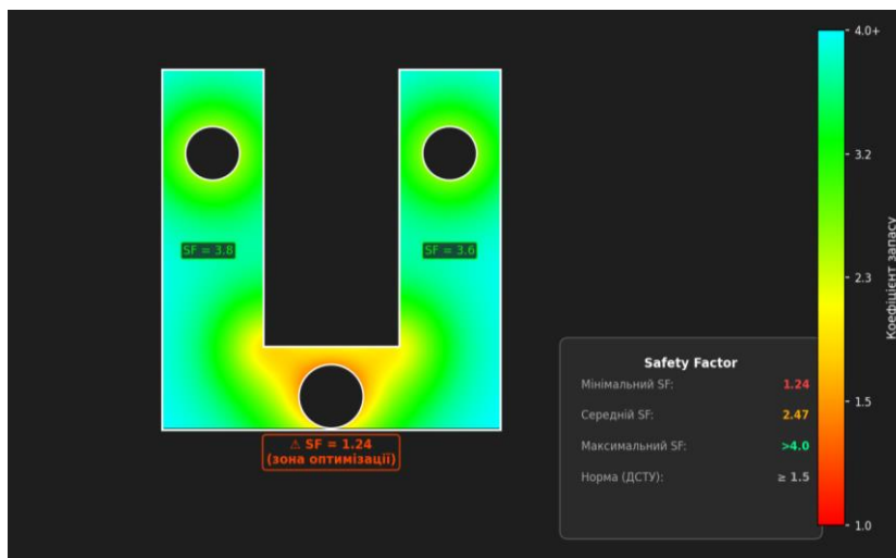
Рис. 3. Розподіл коефіцієнта запасу міцності Safety Factor
