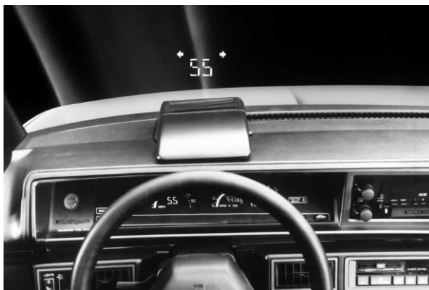
Рис. 1. Перший серійний автомобільний монохромний HUD
