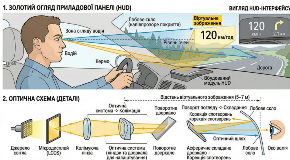
Рис. 3. Оптична схема роботи системи Head-Up Display
