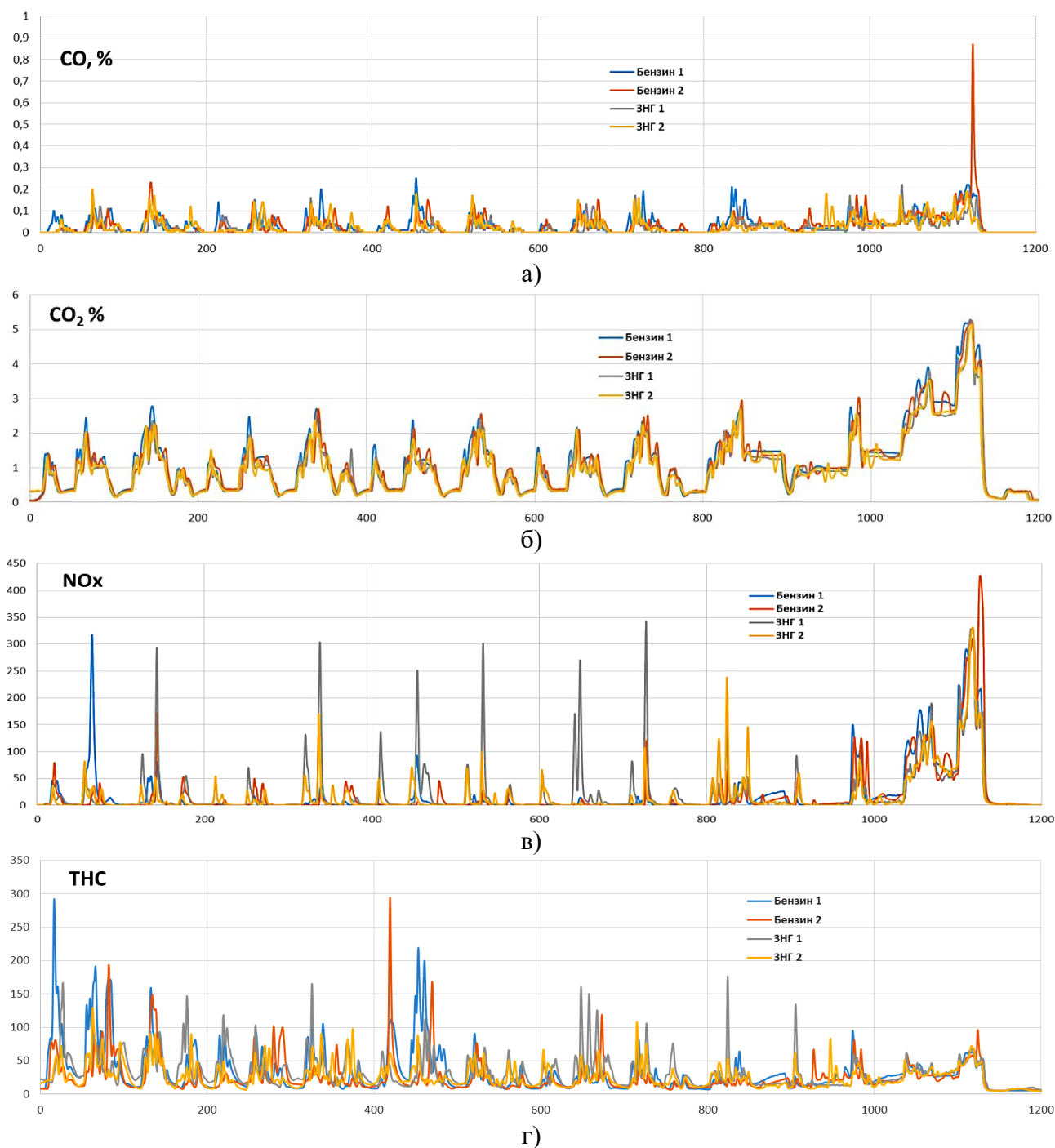
Рисунок 2 – Результати експериментального дослідження ТЗ KIA CEE'D 2.0 5MT2, переобладнаного для роботи на газовому паливі: а) викиди CO; б) викиди вуглекислого газу CO 2 ; в) викиди оксидів азоту; г) загальна кількість вуглеводнів
