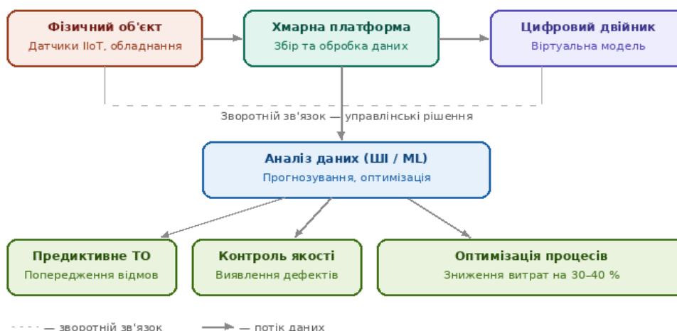
Рис. 1. Архітектура системи цифрового двійника в автомобільному виробництві
