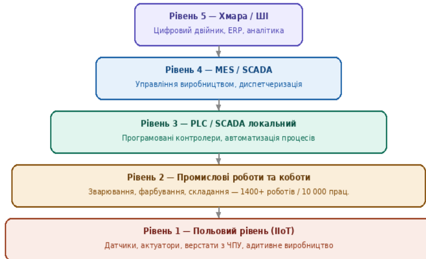
Рис. 2. П'ятирівнева піраміда автоматизації виробничих процесів (Індустрія 4.0)
