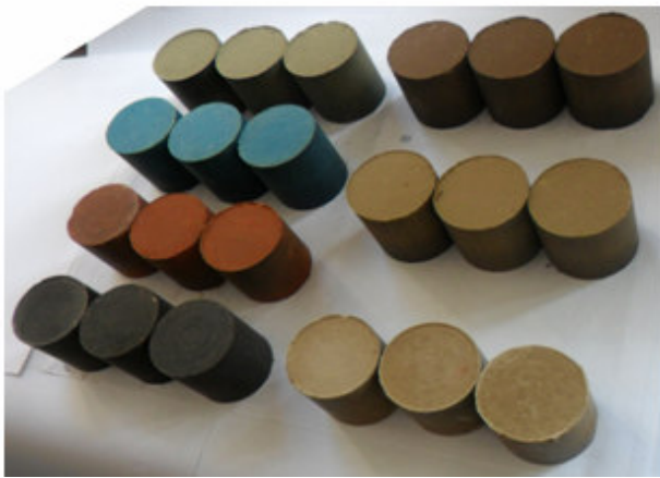
Рисунок 1 – Фото заформованих зразків-циліндрів 50x50 мм
