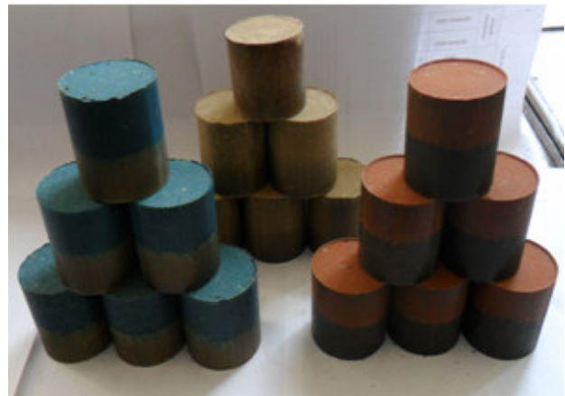
Рисунок 1 – Фото заформованих зразків-циліндрів 50x50 мм
