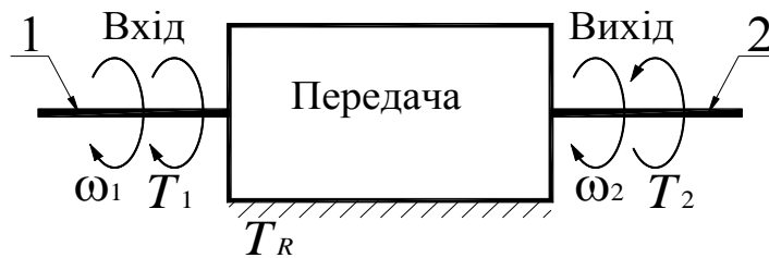
Рис. 3.10. Схема механічної передачі
