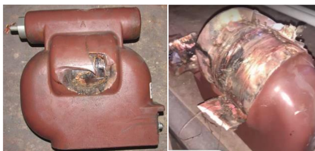
Рис. 1. Приклади пошкоджених ТН з литою ізоляцією
