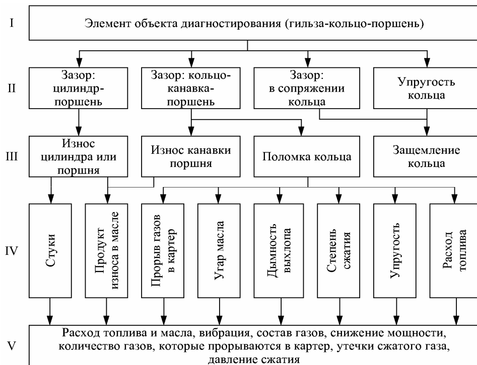
Рис. 9.9. Структурно-наследственная диагностическая модель цилиндропоршневой группы двигателя
